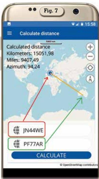
zimuth non viene fornito riferendoci a una sola griglia. Detto questo accedendo al menu in alto a sinistra nell'app (figura 6) vedrete che oltre a lanciare la propria posizione c'è la possibilità di calcolare la distanza tra due griglie con l'opzione "Calculate distance" che una vol-
