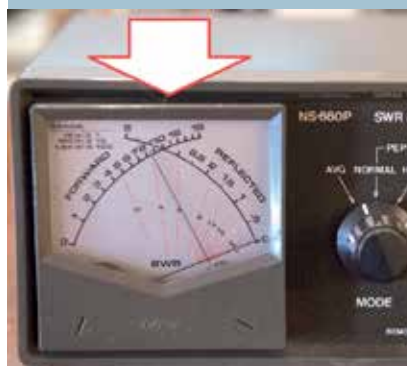
Figura 8 - Il rosmetro ad aghi incrociati usato per le prove, modello Daiwa NS-660P, posto all'ingresso dell'accordatore (lato RTX), indica una potenza diretta di 8,5 W, ed una potenza riflessa praticamente nulla.
