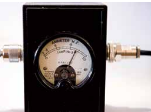
Figura 15 - L'amperometro RF utilizzato nelle prove, uno strumento vintage a termocoppia, in grado di misurare correnti RF, nello spettro HF, fino ad 1 A.
