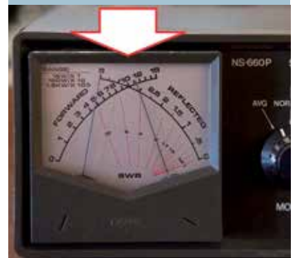
Figura 9 - Qui il rosmetro è posto all'uscita dell'accordatore (lato antenna), e sulla scala della potenza diretta indica circa 11 W, mentre su quella della potenza riflessa indica 5W.
