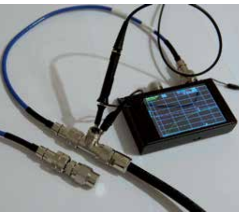
Figura 10 - In primo piano l'aspetto di un connettore N maschio seguito da un barilotto femmina-femmina ed uno standard di misurazione sempre N maschio, paragonato alla fixture per la misura dell'impedenza e della tensione descritta nel testo. La posizione del piano di misura dello standard di calibrazione coincide col punto dove è inserita la sonda oscilloscopica. Il NanoVNA utilizzato è la versione SAA-2N (2.2).
