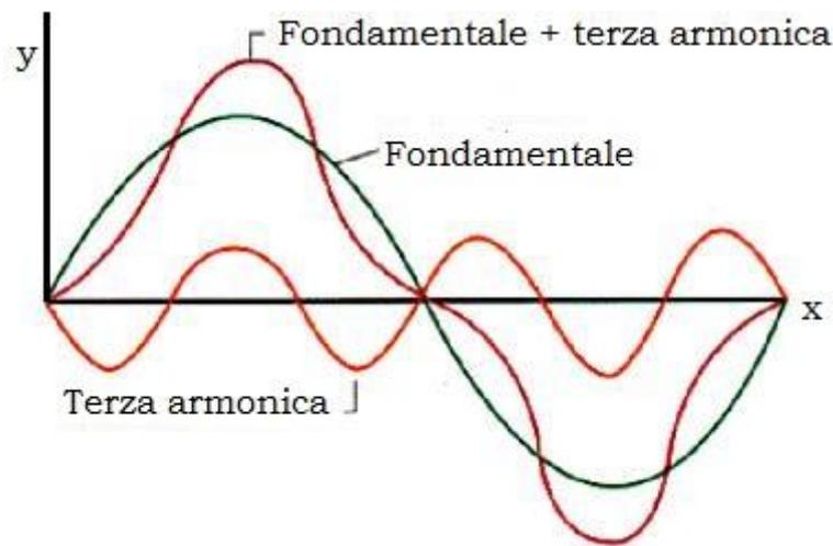
**-ONDA FONDAMENTALE**: è l'onda sinusoidale che ha la stessa frequenza del segnale complesso di partenza.
